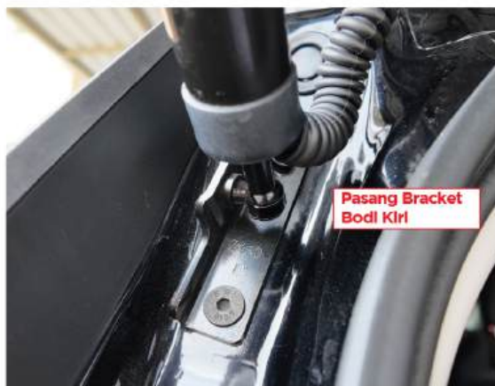
6. Ganti bracket bawaan mobil dengan bracket bodi kiri RWB.
