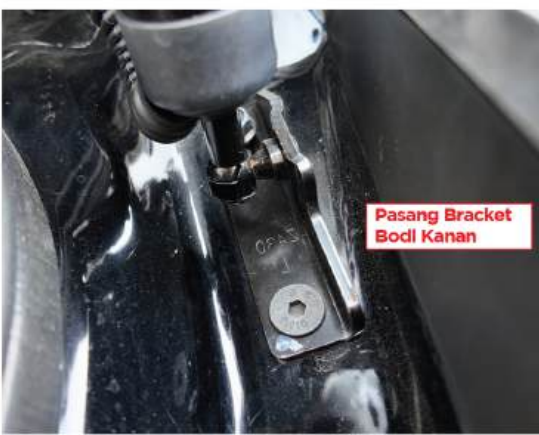
7. Ganti bracket bawaan mobil dengan bodi kanan RWB.
