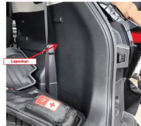
4. Keluarkan karpet lantai bagasi dan lepas panel trim yang ditunjukkan.
