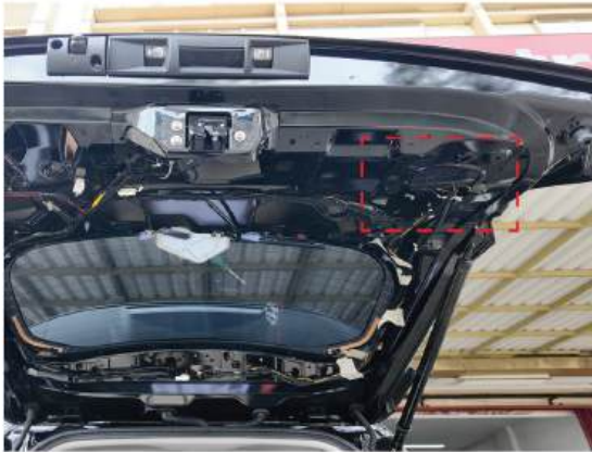
24. Kencangkan ECU di posisi yang ditunjukkan dengan mur dan pastikan sisi socket menghadap keluar.
