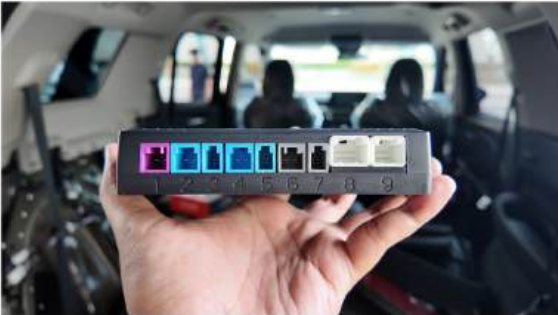
25. Masukkan kabel strut kiri dan kanan (1) (2), kabel sinyal pengunci (3), dan kabel power (4) ke dalam ECU secara berurutan.
