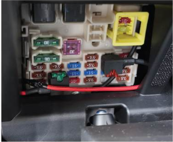
22. Colokkan fuse tap ke kotak sekering dan perhatikan arah kabel.
