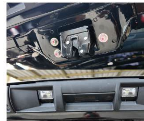
14. Pasang motor pengunci elektrik dan sambungkan konektor socket kabel sinyal pengunci ke saklar pintu bagasi tambahan.
