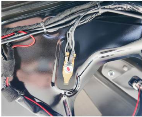
18. Ground pada posisi seperti di foto.
