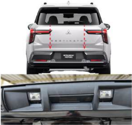
26. Tekan saklar pintu bagasi tambahan untuk menutup pintu bagasi sekali. Sistem akan melakukan inisialisasi, kemudian uji semua fungsi dari pintu bagasi elektrik.
