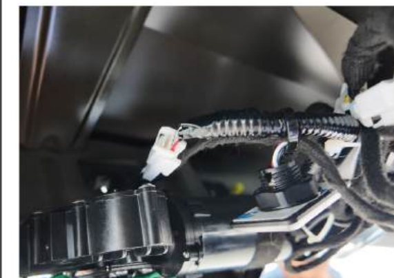
15. Sambungkan konektor kabel sinyal pengunci ke saklar pintu bagasi bawaan.
