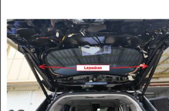
5. Lepas tiang strut/penyangga hidrolik bawaan ori mobil.
