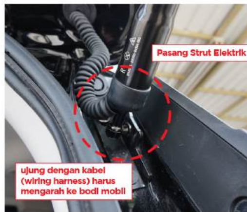
8. Pasang strut hidrolik elektrik, 'L' untuk sisi kiri, dan 'R' untuk sisi kanan
