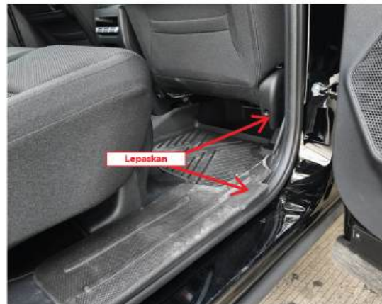
2. Lepas panel ambang pintu belakang kanan dan panel trim pilar B.
