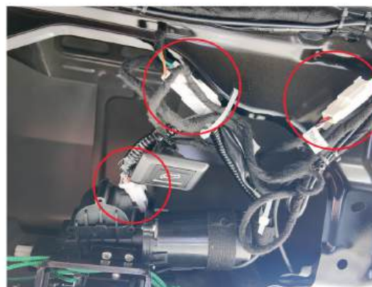
13. Sambungkan konektor kabel sinyal pengunci ke motor pengunci elektrik.
