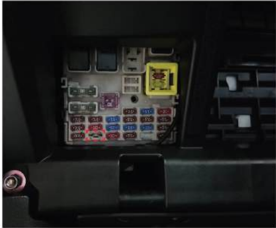
21. Kotak sekering terletak di area ini, dan slot untuk daya ditunjukkan.
